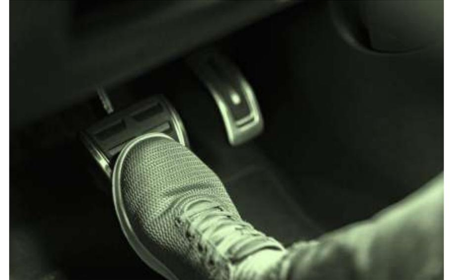
Bei manchen Fahrzeugen kann eingestellt werden, dass sie **bis zum Stillstand abbremsen**, wenn der Fuß vom Strompedal genommen wird. Dadurch kann nahezu ohne Nutzung des Bremspedals gefahren werden, also mit nur **einem Pedal**. Beim Abbremsen bis zum Stillstand ohne das Bremspedal wird vom Fahrzeug jedoch auch die mechanische Bremse genutzt.
