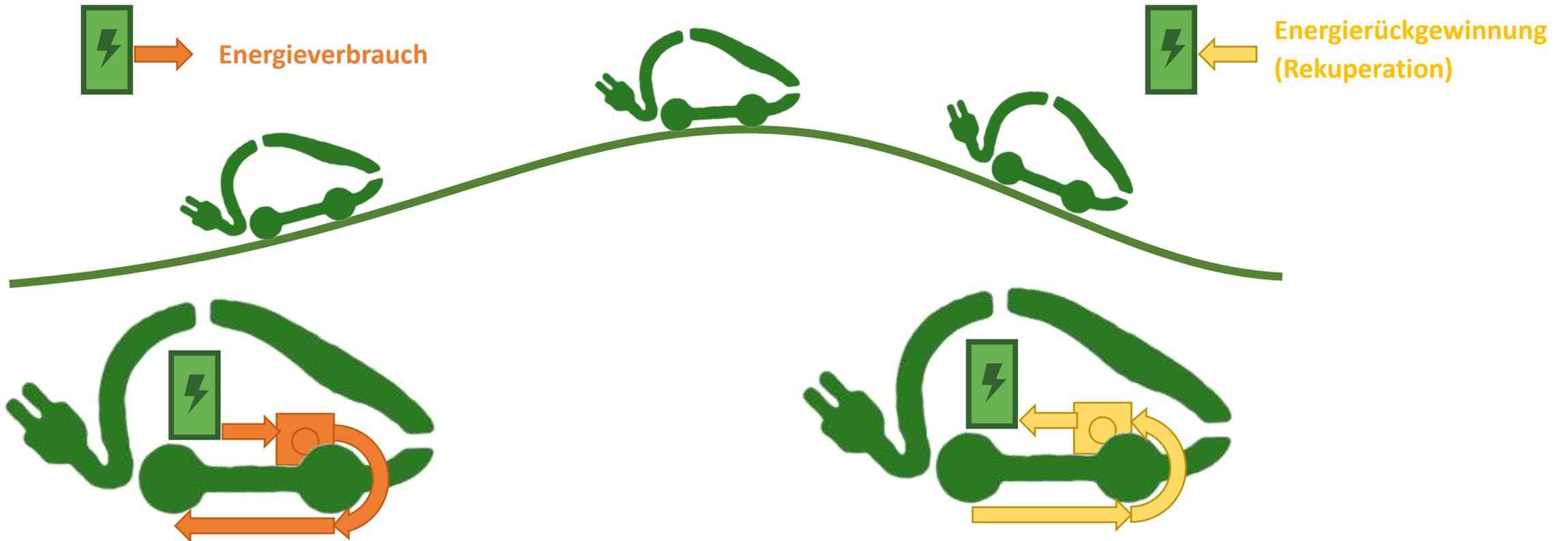
Beim **Beschleunigen und Bergauffahren** wird Energie benötigt, diese wird vom Akku über den Elektromotor an den Antrieb abgegeben.
